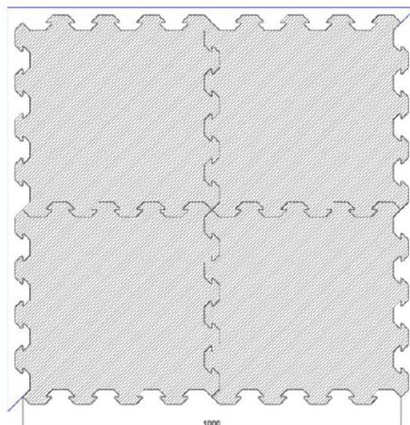
La pavimentazione Tappeto E.V.A. nelle versioni "Easy e Soft" è facile da installare e reinstallare senza particolari difficoltà. Il caratteristico sistema ad incastro autobloccante a martello, permette una facilità di aggancio con conseguente risparmio di tempo nella posa ed economica rimozione/sostituzione dei moduli. Sagomabile all'occorrenza su misura per qualsiasi esigenza e dimensione del supporto da rivestire. Garantisce un elevato standard di sicurezza nel caso di urti e di cadute.
